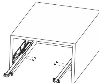
2. На выдвинутые элементы направляющих установите ящик так, чтобы отверстия на боковых стенках совпали с цапфами направляющих.
