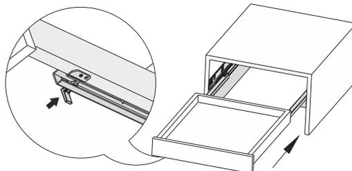
4. Для снятия вытяните фиксаторы на направляющих. Поднимите и выдвиньте ящик.
