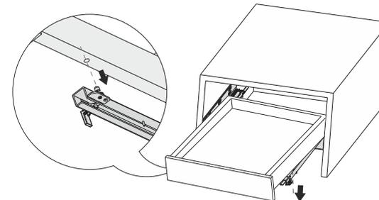
3. Нажмите на фиксатор на направляющих чтобы зафиксировать ящик. Задвиньте ящик в корпус.
