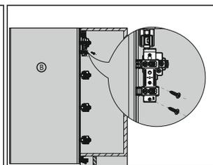
Зафиксируйте створку с помощью винтов
