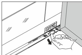
Нажмите на курки фиксаторов и выдвиньте ящик
