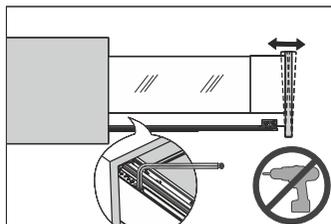
Регулировка наклона фасада
