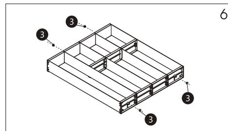
Внимание: пожалуйста, установите бампер, если между лотком и передней/задней панелью ящика имеется зазор
